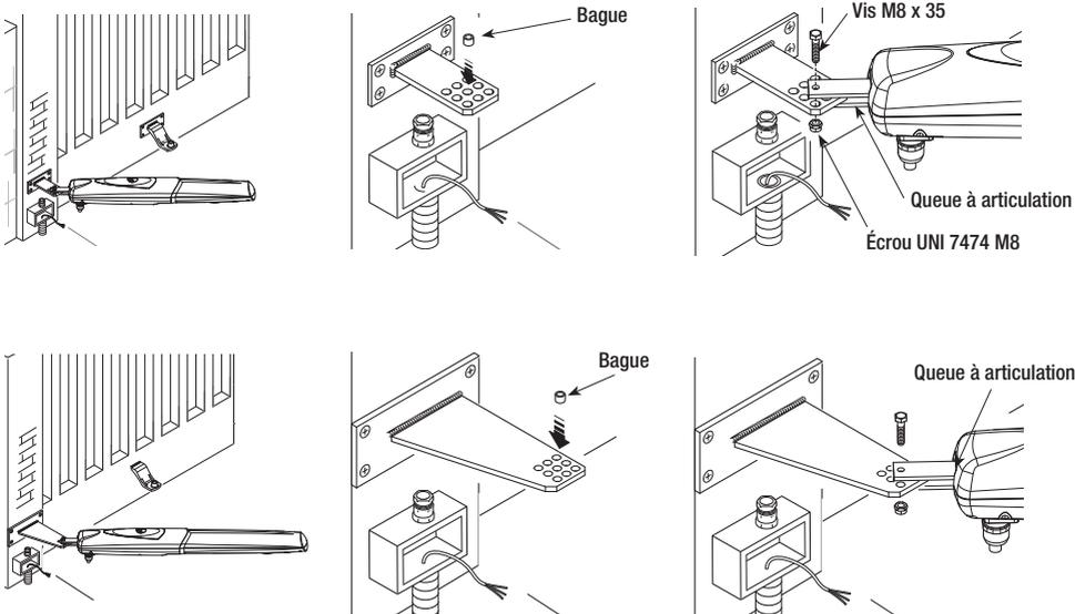
Ouvrez la porte et introduisez la broche dans l'étrier portail et fixez-la avec la rondelle et l'écrou.
