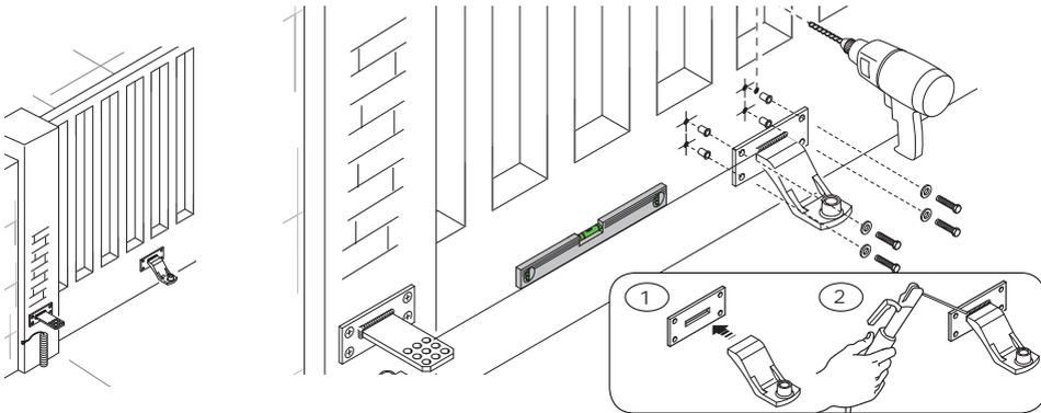
Introduisez la bague (graissée) dans le trou de l'étrier pilier. L'étrier est muni de trous qui permettent de varier l'angle d'ouverture du portail. Fixez la queue à articulation à l'étrier.
